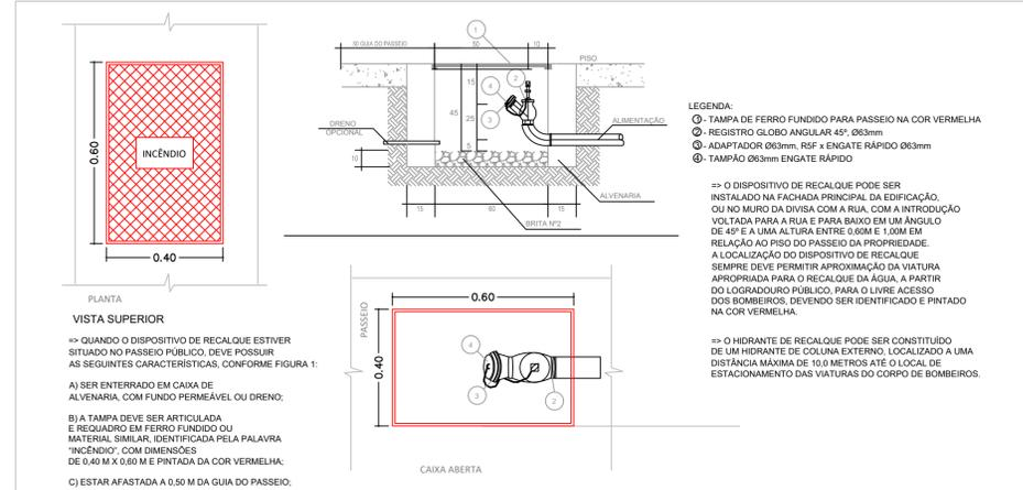
**DETALHE - INSTALAÇÃO HIDRANTE SEM ESCALA**
